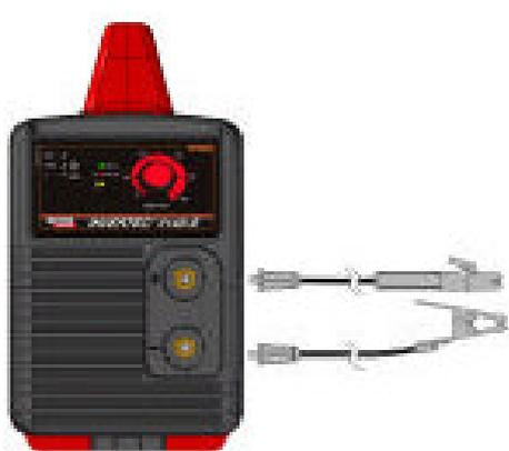
Для сварки на прямой полярности DC(-) следует подключить электродный кабель к терминалу "-", а кабель на деталь к терминалу "+".
