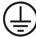
Рама сварочного аппарата должна быть заземлена. Клемма заземления обозначена соответствующим символом на панели аппарата. Для выбора правильного способа заземления, обратитесь к локальным электротехническим стандартам.
