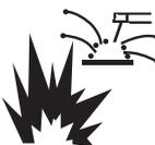
**Искры, образующиеся в процессе СВАРКИ, СТРОЖКИ МОГУТ СТАТЬ ПРИЧИНОЙ ВЗРЫВА ИЛИ ПОЖАРА**
