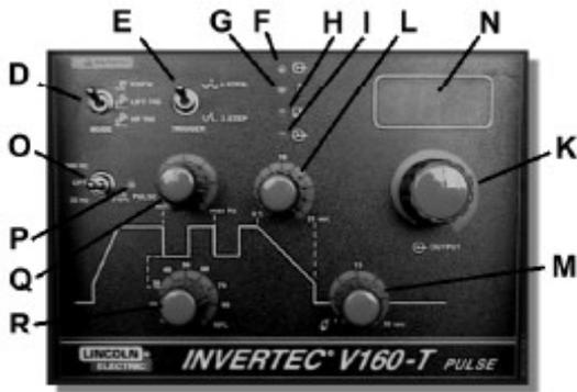
D. Переключатель сварочных режимов – служит для переключения сварочных режимов. Сварочный источник Invertec V160-S может работать в двух сварочных режимах: режиме ручной дуговой сварки "Stick" и режиме аргонодуговой сварки с зажиганием дуги точечным касанием электрода "Lift TIG". Модификация Invertec V160-T работает в трех режимах: режиме ручной дуговой сварки "Stick", режиме аргонодуговой сварки с зажиганием дуги точечным касанием электрода "Lift TIG" или с помощью осциллографа "HF TIG".
