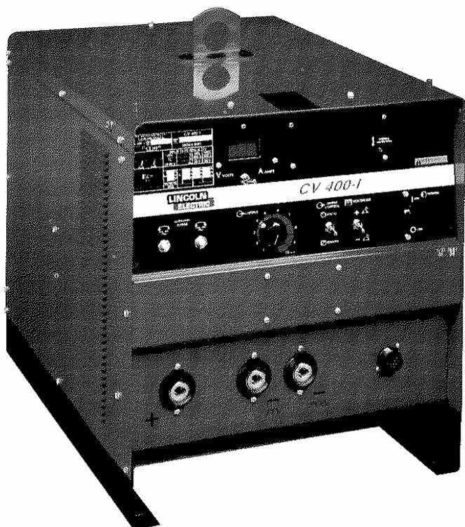
CV 400-I - стационарный сварочный трансформатор-выпрямитель с жесткой вольтамперной характеристикой. Он применяется для полуавтоматической сварки углеродистых и нержавеющей сталей, алюминия и других сплавов. Оптимальные рабочие параметры источника обеспечивают хороший внешний вид сварного шва и стабильность процесса.
