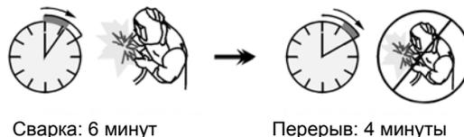
При слишком длительной работе аппарата возможно срабатывание системы тепловой защиты.
