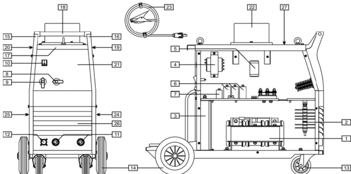
Рисунок А: Сборочный чертеж (PowerTec 300S)
