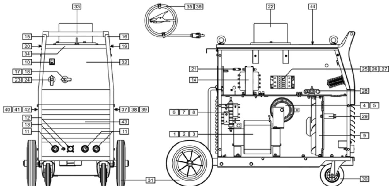
Рисунок В: Сборочный чертеж (PowerTec 360S, 420S, 500S)
