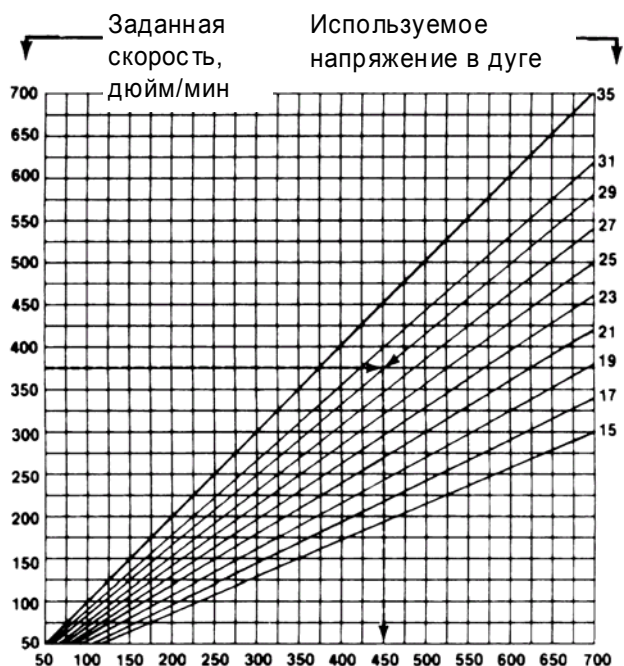
РИСУНОК Б.4 УСТАНОВКА СКОРОСТИ ПОДАЧИ ПРОВОЛОКИ В РЕЖИМЕ ПАДАЮЩЕЙ ВАХ (CC)
