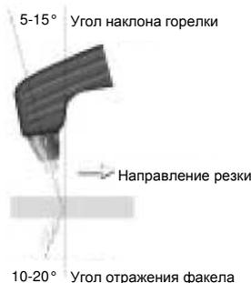
Во время резки горелка должна постоянно перемещаться с одинаковой скоростью, так чтобы угол отражения пламени от точки реза составлял  $10^\circ - 20^\circ$ .
