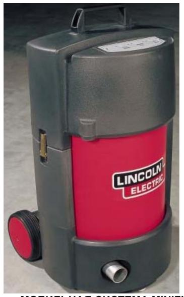
Мобильное высоковакуумное вытяжное устройство MINIFLEX предназначено для очистки окружающего воздуха и удаления сварочных газов и аэрозолей из рабочей зоны сварщика. Система используется при полуавтоматической сварке сплошной и порошковой проволокой в среде защитного газа, полуавтоматической сварке самозащитной порошковой проволокой, аргонодуговой и ручной дуговой сварке.
