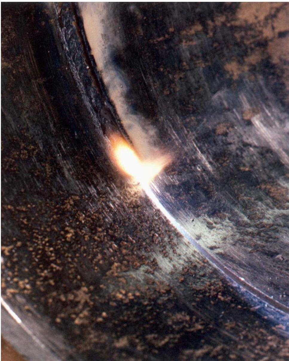
*Формирование обратного валика при сварке трубы  $\varnothing 203,2 \times 9,5$  мм из стали XL52 в положении 5G. Корневой шов выполняется на участке с 3 до 6 часов с зазором.*
