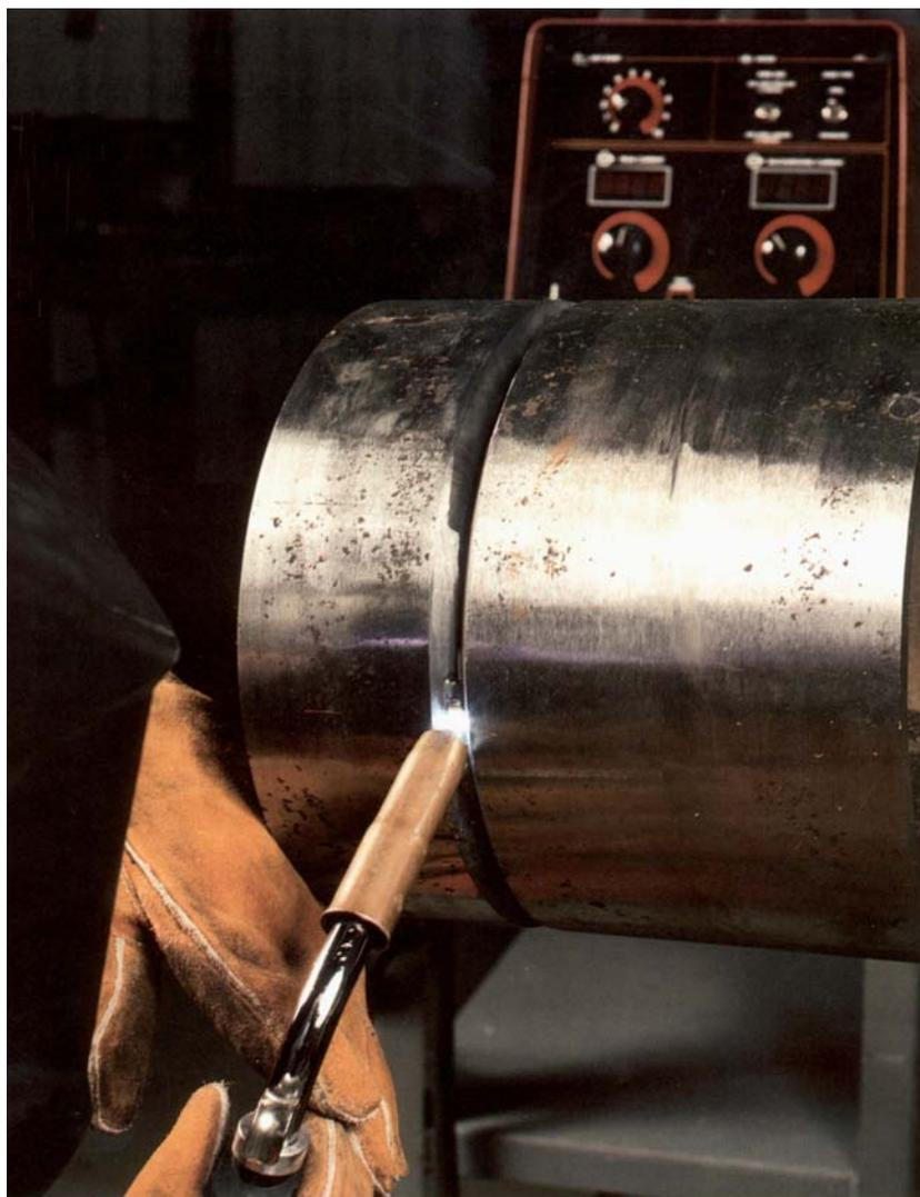
*Процесс STT при сварке проволокой типа ER70S-6 диаметром 1,2 мм (0,045") в среде CO<sub>2</sub>*
