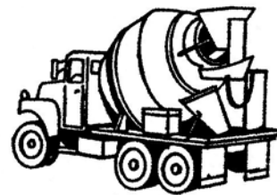
Смесители бетона на автомобилях
