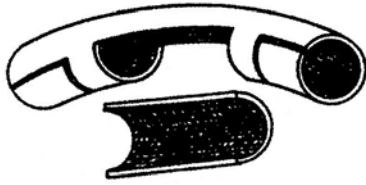
Изгибы трубопроводов для перекачивания абразивных суспензий
